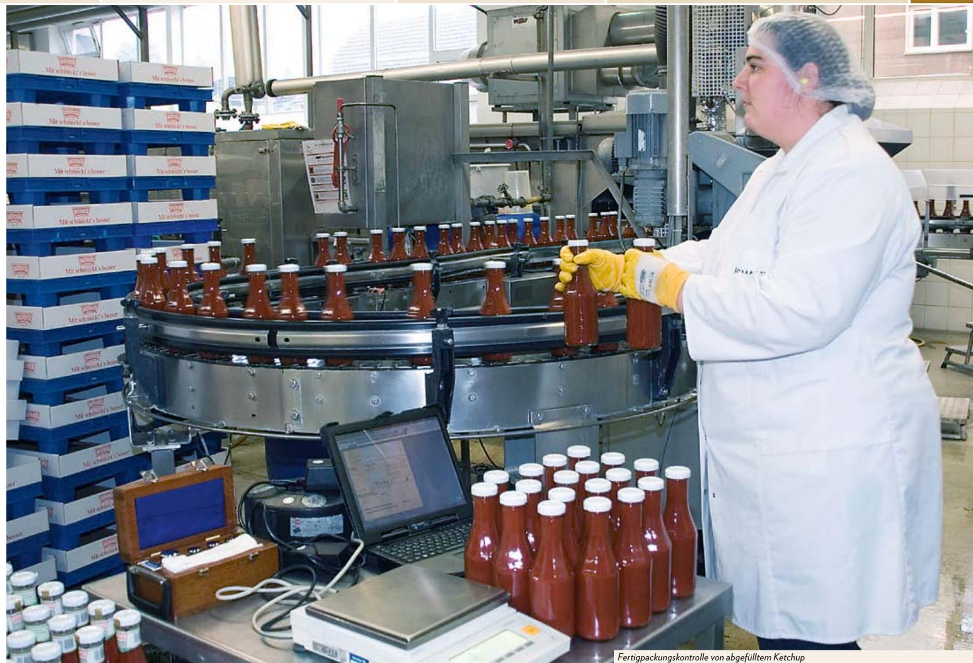
Fertigpackungskontrolle von abgefülltem Ketchup
