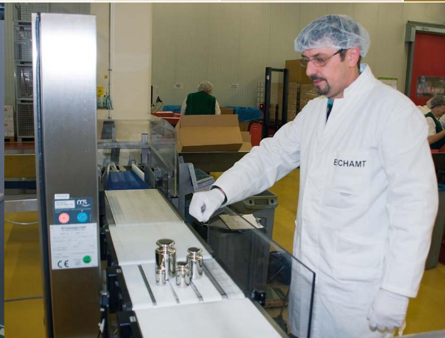
Eichung einer automatischen Waage
