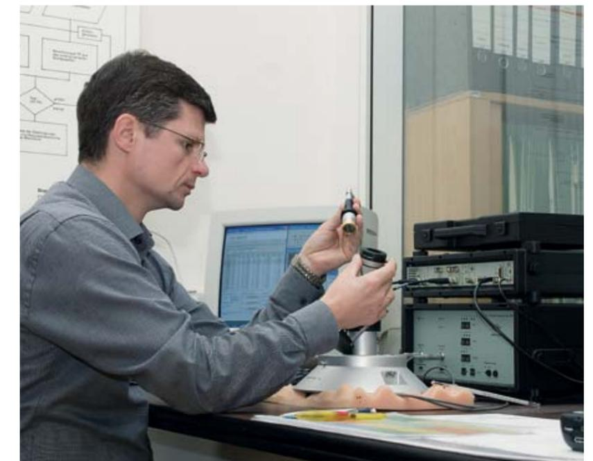
Sorgfältiger Umgang mit Mikrofonen am Reziprozitäts-Messplatz
