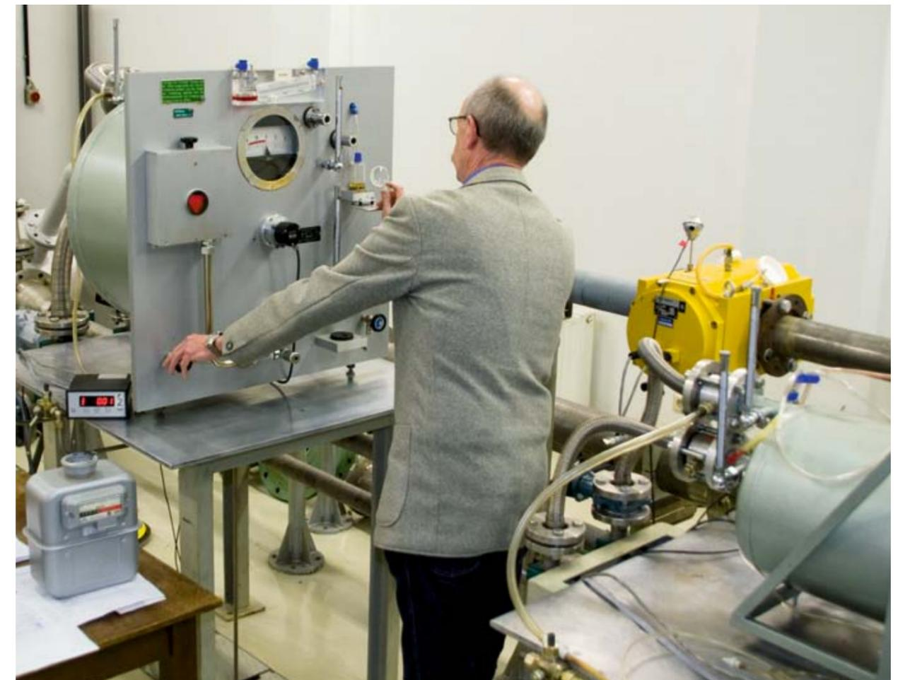
Vorbereitung einer Befundprüfung eines Gaszählers im Labor des Eichamtes
