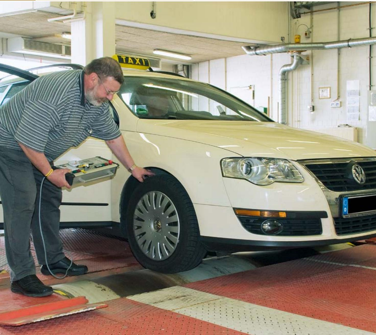
Eichung eines Fahrpreisanzeigers auf dem Rollenprüfstand der Außenstelle Berlin
