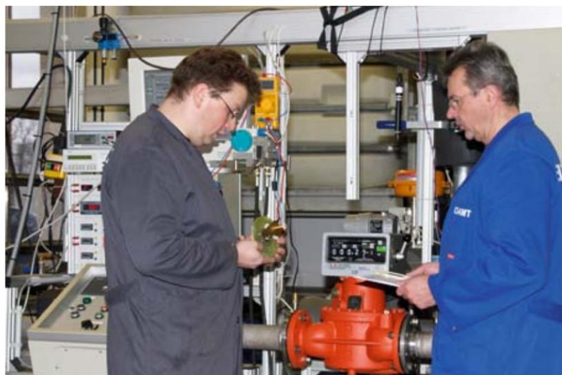
0,08% bei Kalibrierungen und Prüfungen von Zählern machen ihn einzigartig. Regelmäßige Ringversuche und Vergleichsmessungen mit Prüfständen anderer Institutionen, z.B. der Physikalisch Technischen Bundesanstalt und von Eichaufsichtsbehörden, haben diese wiederholt nachgewiesen (1).
