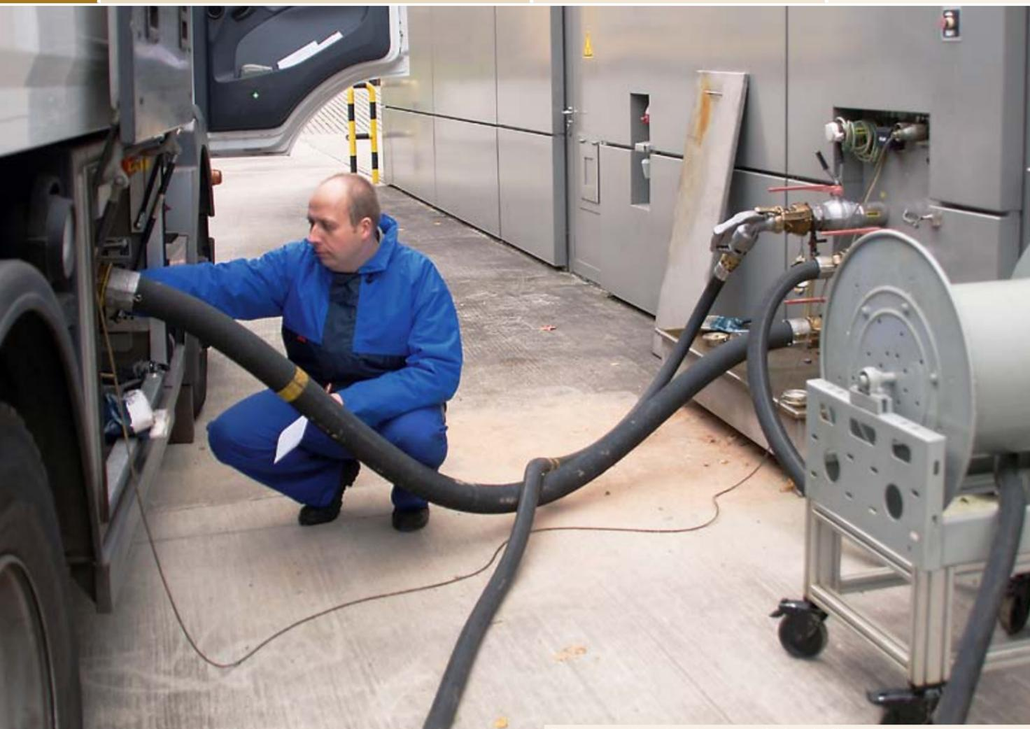
Eichung eines Mineralöltankwagens am Prüfstand in Kleinmachnow
