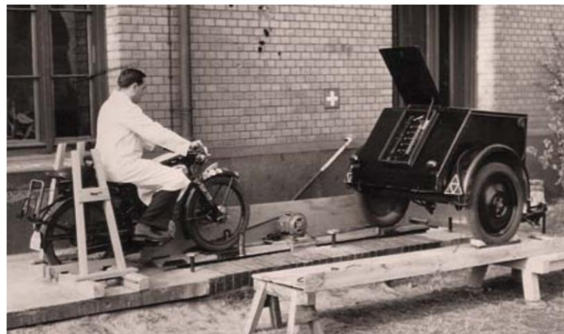
Prüfstand für Wegstreckenzähler an Motorrädern. Not macht erfinderisch, sagt der Berliner. Da der Messwagen mit Wegstreckenzählern bei Motorrädern nicht mitgeführt werden konnte, ersetzte ein schmales Laufband (angetrieben durch einen Elektromotor) die Straße. Technisch einfach, aber messtechnisch wirkungsvoll.
